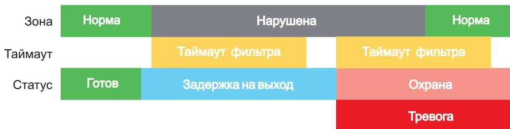
Рисунок 12. Нарушение зоны в момент постановки на охрану.
