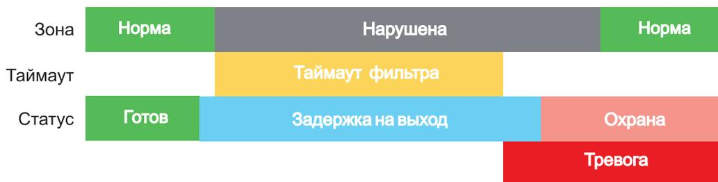
Рисунок 9. Превышен тайм-аут фильтра для зоны периметр во время задержки на выход
