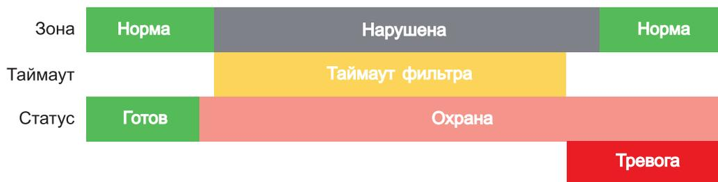
Рисунок 7. Тревога при нарушении по окончании тайм-аута.
